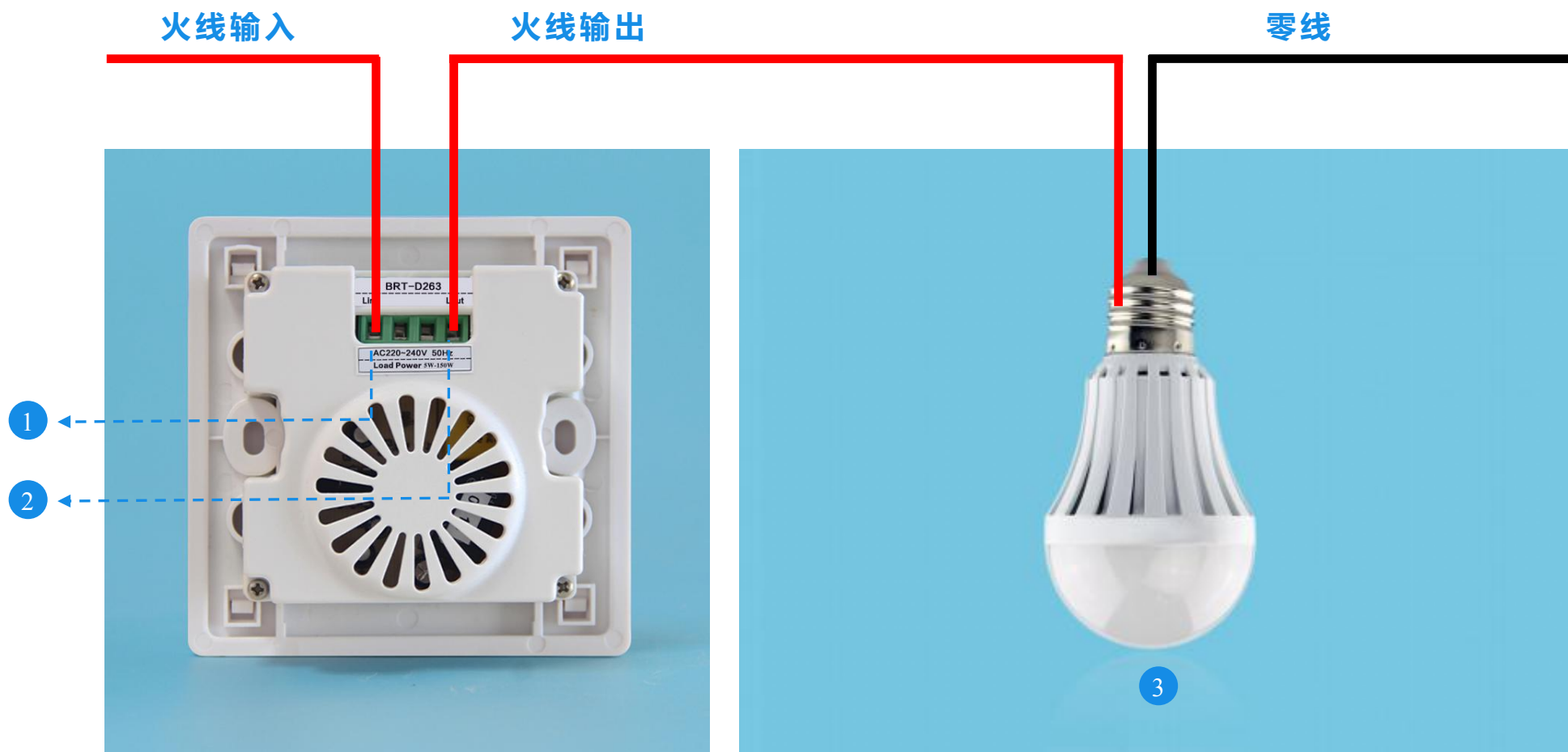
标注：① Lin：火线输入接口 ② Lout：火线输出接口 ③ 负载（LED 灯泡）
