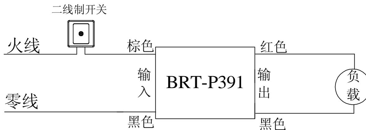
接线方法:如图所示,输入端棕色线接开关的输出端,黑色线接零线;输出端红色线接负载的火线,黑色线接负载的零线.
